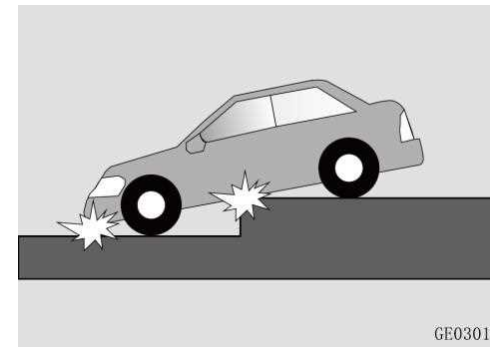
۳. اگر وسیله نقلیه به یک چاله یا گودال عمیق بیفتد یا قسمت اصلی شاسی ضربه خورده باشد.
